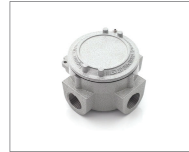
Взрывозащищенная коробка 1Ex d IIC T6 Cb, IP66, 4 отв. 1/2"NPT, Артикул: LE 1261
